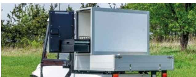
Zona de carga mixta, combinando armario cerrado y espacio 'pick up'.
